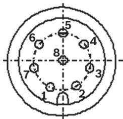
Obr. 8: Osazení kontaktů (pohled shora na víko senzorů)
